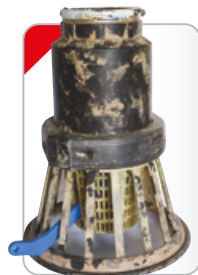
Válvula de pie sin haber sido sometida al mantenimiento requerido.
